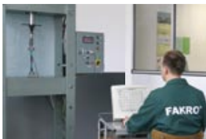
Badanie wytrzymałości folii na rozerwanie
